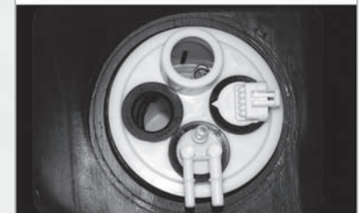
Conjunto de módulo de bomba de combustible correctamente posicionado
