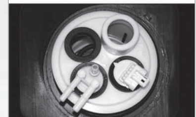
Conjunto de módulo de bomba de combustible incorrectamente posicionado
