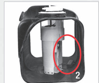
Conjunto de módulo de bomba de combustible correctamente posicionado
